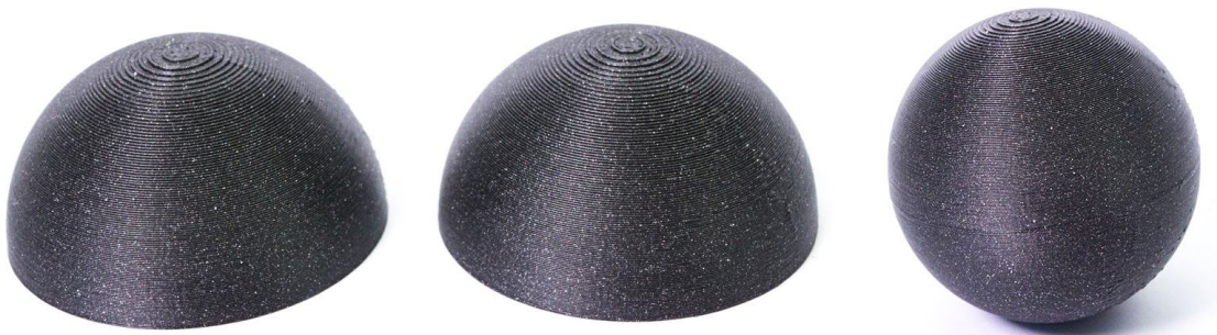
Obr. 29 - Koule vytištěná na dvě části a následně slepená dohromady
