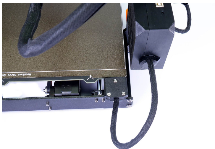
Obr. 49 - Kabely spirálovitě omotané kroucenou bužírkou
