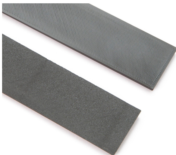
Obr. 7 - Vliv povrchu na první vrstvu - hladký PEI povrch (nahore) vs zrnitý práškový PEI povrch (dole)
