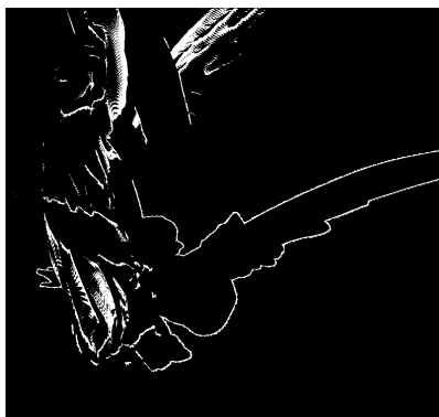
Obrázek 3.3: Třetí průchod – stínová tělesa. Náhled na stencil buffer. Plocha hran je menší oproti obrázku 3.2a.
