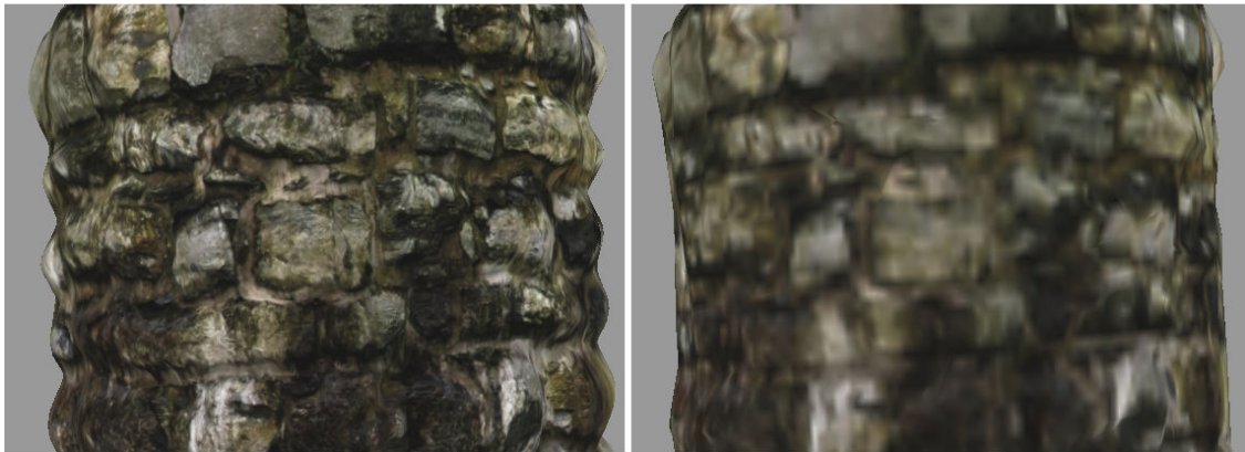
Obrázok 4.2: Ukážka výsledku simplifikácie geometrie a aj zmenšenie textúry. Vľavo je 80 000 polygónový model a vedľa je jeho približne 1 000 polygónová redukcia so zmenšenou textúrou.
