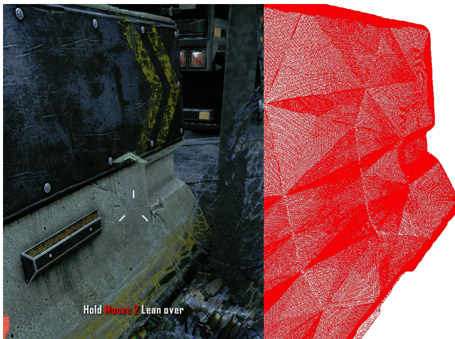
Obrázek 4.2: Crysis 2 - ukázka zbytečně teselovaných oblastí modelu. zdroj: [18]
