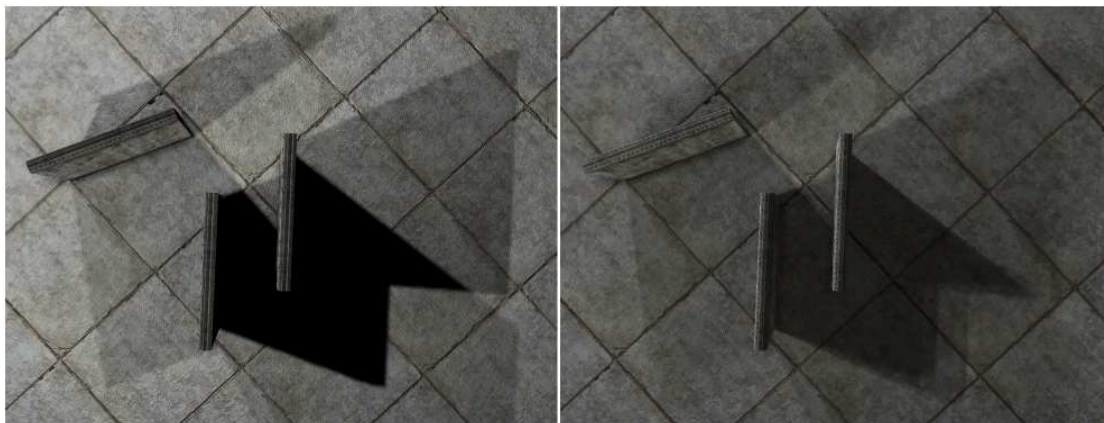
Obrázek 2.5: Srovnání klasického výpočtu s Global Illumination
